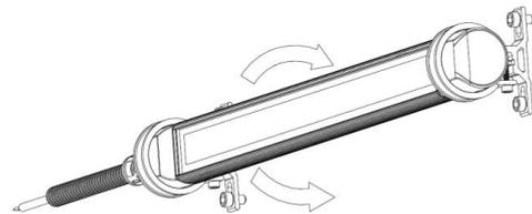
3. Ziehen Sie die Schrauben mit einem Inbusschlüssel fest.
